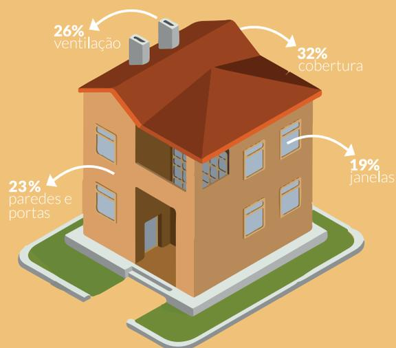
Exemplo de perdas térmicas pela envolvente para uma habitação T3 com 136 m<sup>2</sup> de área útil situada no último piso de um edifício multifamiliar.
